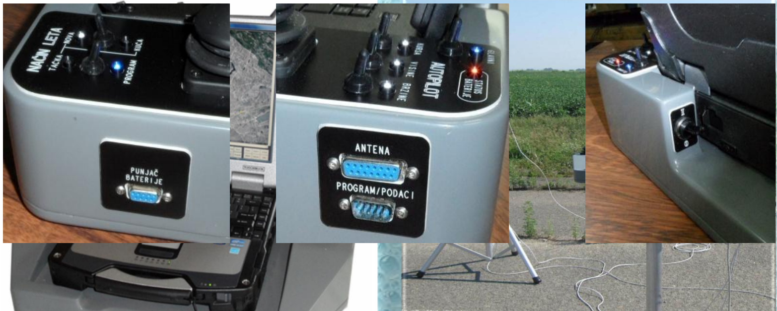
Сл.41 - Управљачки пулт земаљске станице - станице за управљање (управљачка конзола (0)+ лаптоп рачунар(6) = радна станица)
